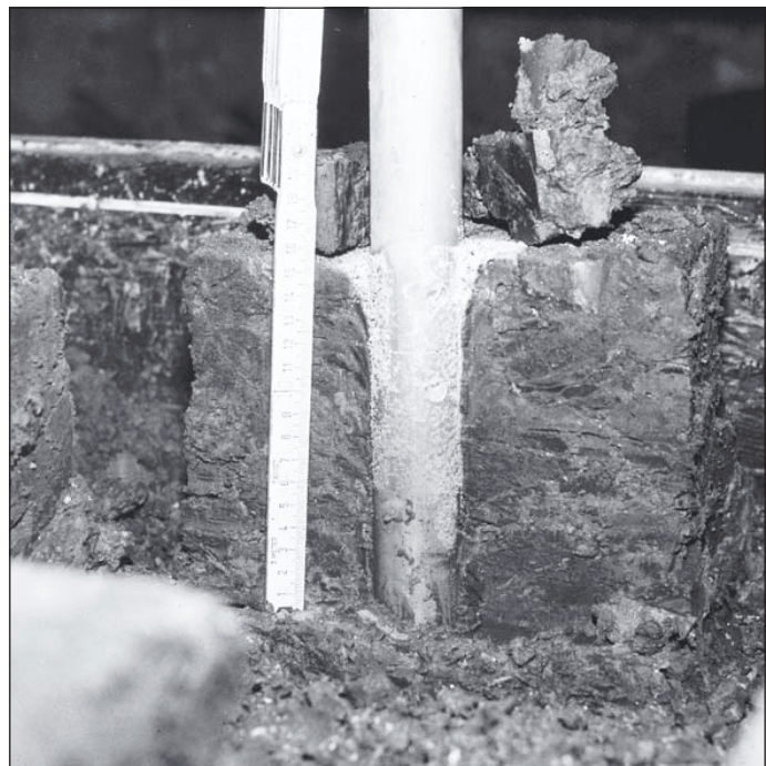
Bild 6: Verschleppungstrichter bei einem Rammrohr mit Fußplatte im Modellversuch
